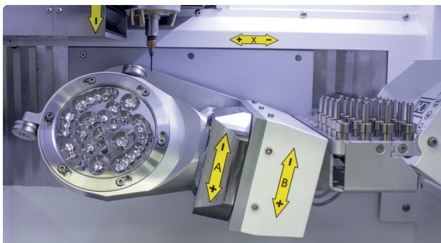
Nullpunktspannsystem für automatisches und zeitsparendes Handling.
