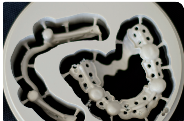
Tizian PEEK für das Fräsen von metallfreien Konstruktionen.
