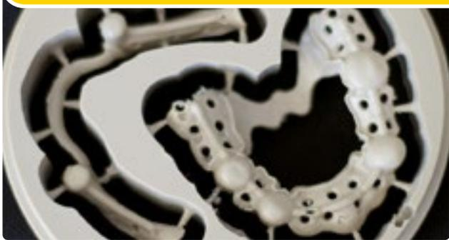
Tizian PEEK für das Fräsen von metallfreien Konstruktionen.
