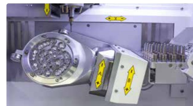
Nullpunktspannsystem für automatisches und zeitsparendes Handling.
