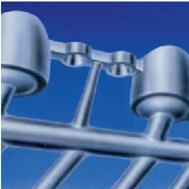
Auch bei Stegkonstruktionen ist es wichtig, in der Mitte einen Hilfsgussstift anzubringen, um einen einwandfreien Guss zu gewährleisten.
